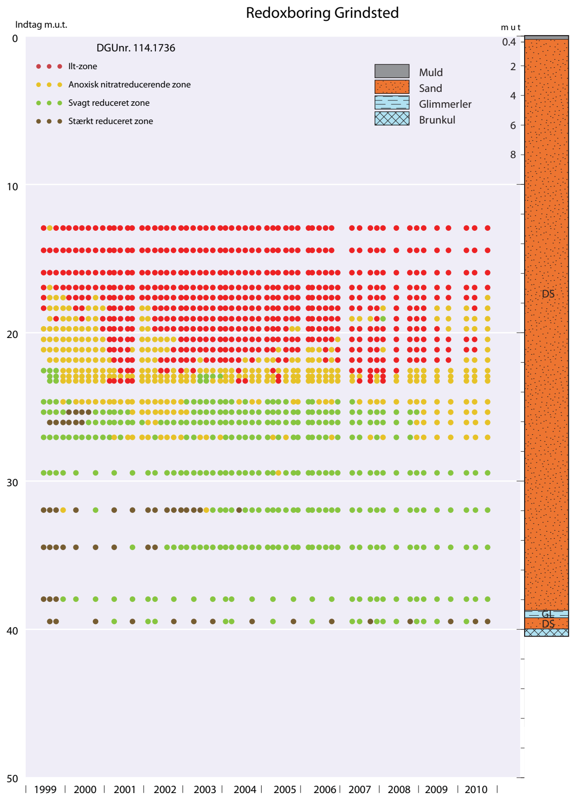
Figur 19. Redoxzoner 23- 40 m.u.t for redoxboring DGU 114.1736, Grindsted 2000-2010. Grundvandsspejl i ca. 6 m.u.t. Den geologiske lagserie er vist længst til højre.
